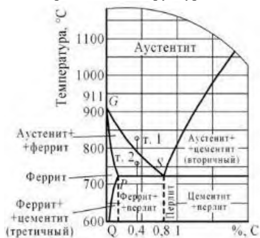
Аустенит неоднороден по химическому составу. В тех местах, где были пластинки цементита, аустенит богаче углеродом, а где пластинки феррита - беднее. Поэтому при термической обработке для выравнивания химического состава зерен аустенита сталь нагревают немного выше критической точки A_{c3} (на 30-50°C) и выдерживают некоторое время при этой температуре. Процесс аустенизации идет тем быстрее, чем выше превышение фактической температуры нагрева под закалку относительно температуры A_{c3} .
