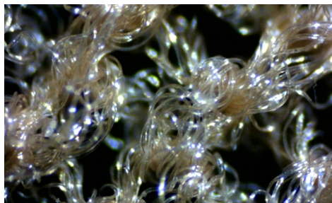
Рис. 9. Капроновая ткань под микроскопом
